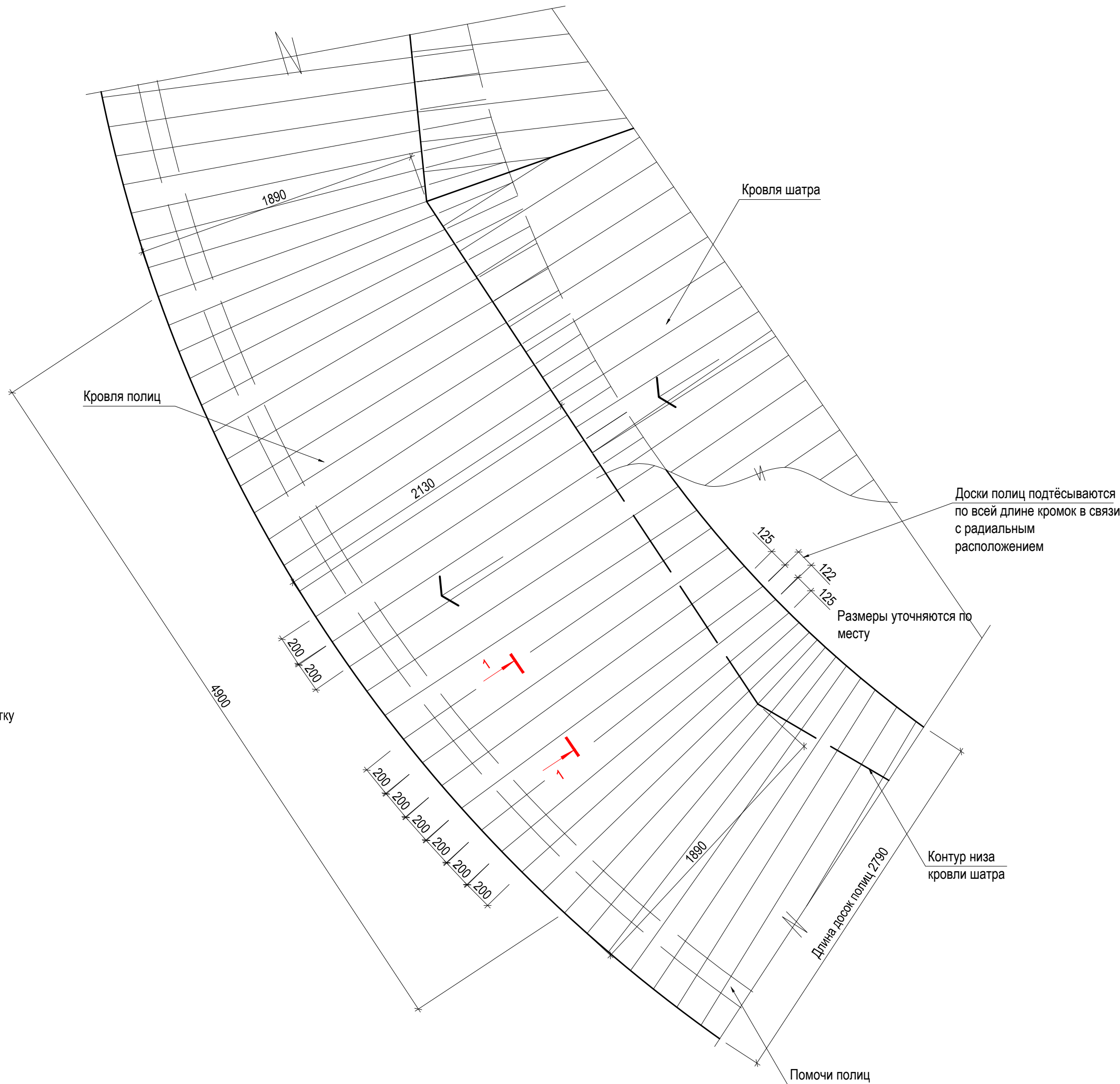
Деталь покрытия полиц шатра м 1:25
